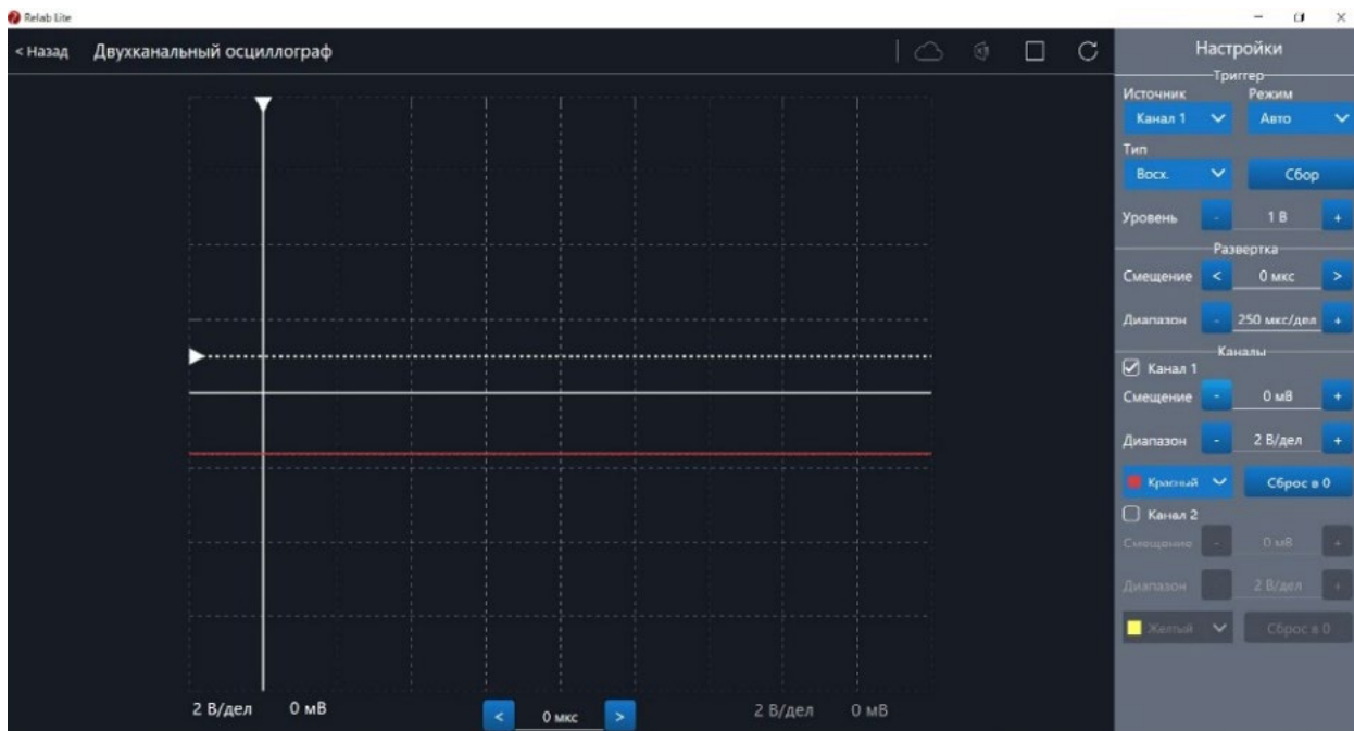
Рис. 40. Сигнал с ненулевым смещением
